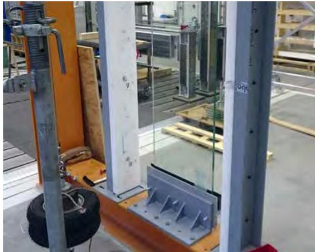
**Pendelschlagversuch nach DIN EN 12600 unter DIN 18008-4**
